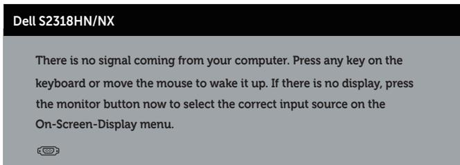
Jika VGA atau kabel HDMI tidak tersambung, maka kotak dialog melayang akan ditampilkan di bawah ini. Monitor akan beralih ke Mode Hemat Daya setelah 4 menit dibiarkan dalam kondisi ini.
